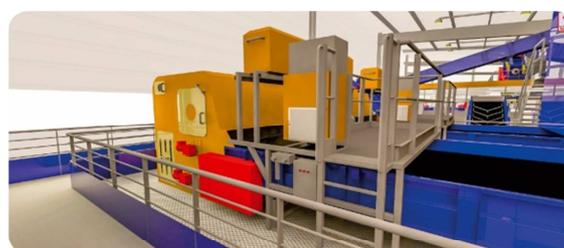
6 trieurs optiques, dont 3 pour faciliter le tri des plastiques, dont le module de tri Recyfilms, spécialement adapté pour les sacs et les films (performance supérieure à 95 %, aspiration et transport aéroulique).
