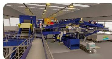
Des passerelles, plateformes d'accès et potences sur les équipements, permettant un entretien plus aisé.
