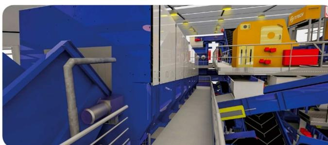
Un pré-tri mécanisé : le trommel actuel sera reconditionné (changement de la maille) et assurera un pré-tri des déchets entrants.
